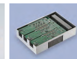
3ポート電力変換技術
