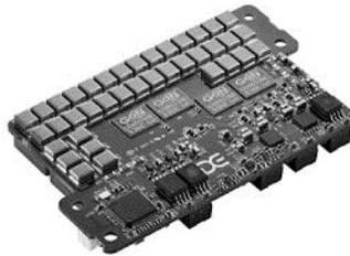
点である寿命、高温対応、薄型化を克服し、かつ約15%の体積低減も実現できる。また、新技術はアクティブパワーデカップリング方式を採用。独自の制御技術
