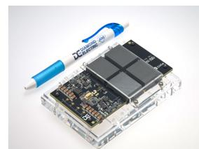
ダイヤモンド電機の超小型・軽量の絶縁双方向電力変換器
